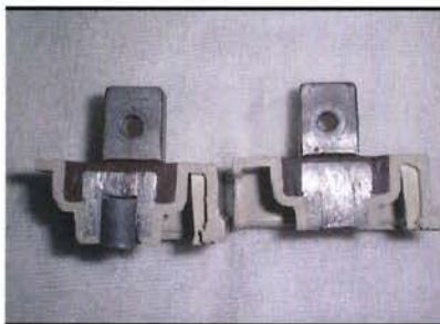
圖 6、故障電池極柱焊接不良
