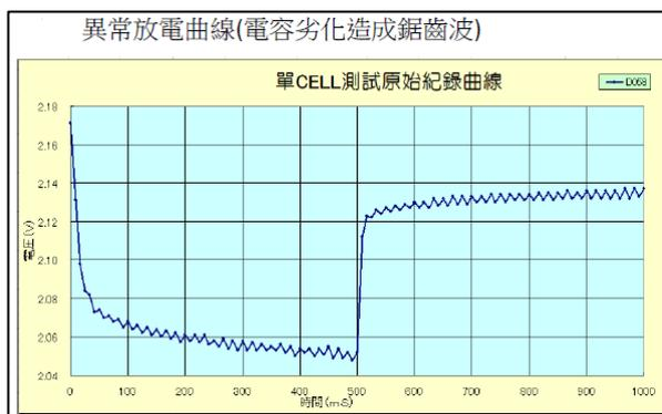
圖七 濾波電容劣化造成異常曲線
