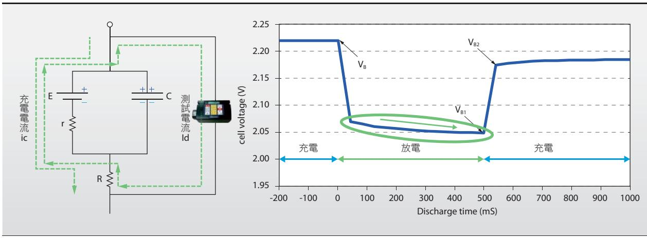
造成如圖右側電池端子電壓急遽下降，此階段為電容電荷放電階段。
