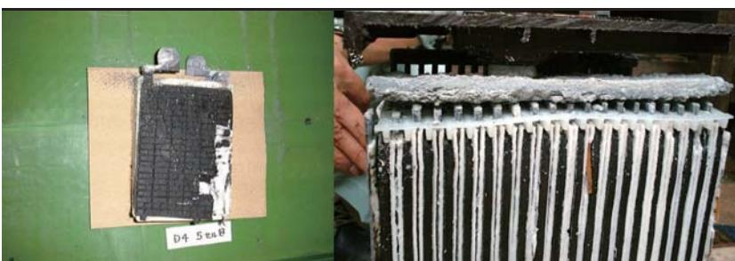
圖 14、極板短路造成超電力異常下降解剖案例
