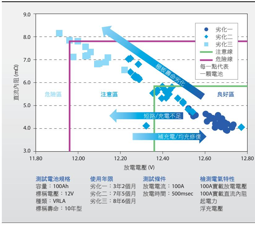
圖 18、電池壽命趨勢推移圖案例
