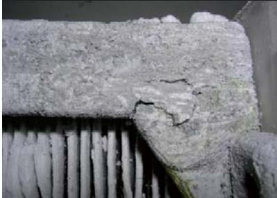
圖 6、故障電池極柱焊接不良
