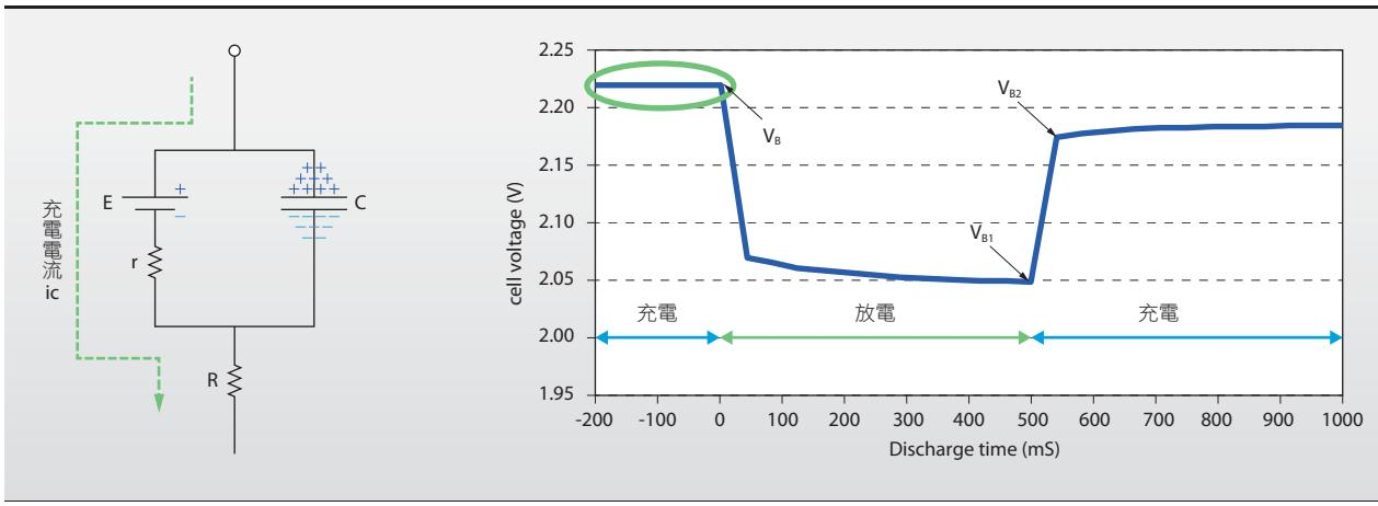
圖 8、電容電荷放電階段
