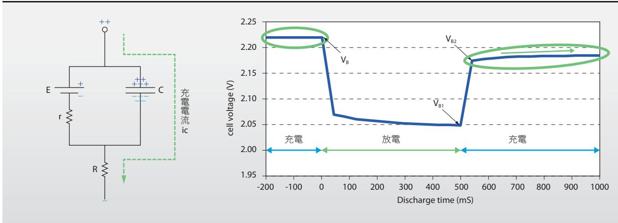
段，將僅出現 STEP2 之電容放電曲線，如 圖 9 右側之電池化學反應供電電壓平台將不會出現，此種電容放電不完全狀態無法有效評估電池實際放電能力。換言之，測試時放電量（放電電流與時間乘積）需足以將電容電荷有效排出，讓電池內部反應物真正起化學反應供電，才能有效實際測試停電時真正電池化學反應的供電能力。
